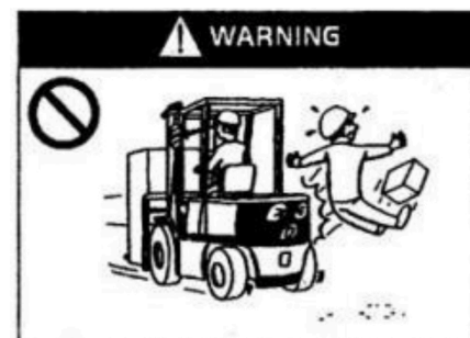
Vigiar permanentemente a presença de peões.
